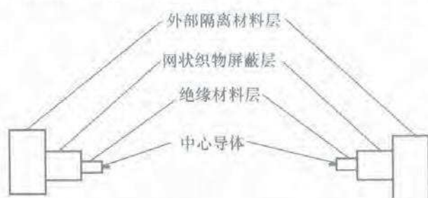
图 2-7 同轴电缆结构图
