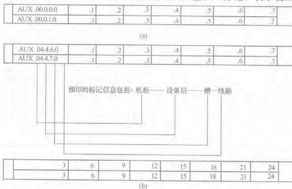
图 8-13 按 3 对线模块化系数排列的引线的黄色插入标记
