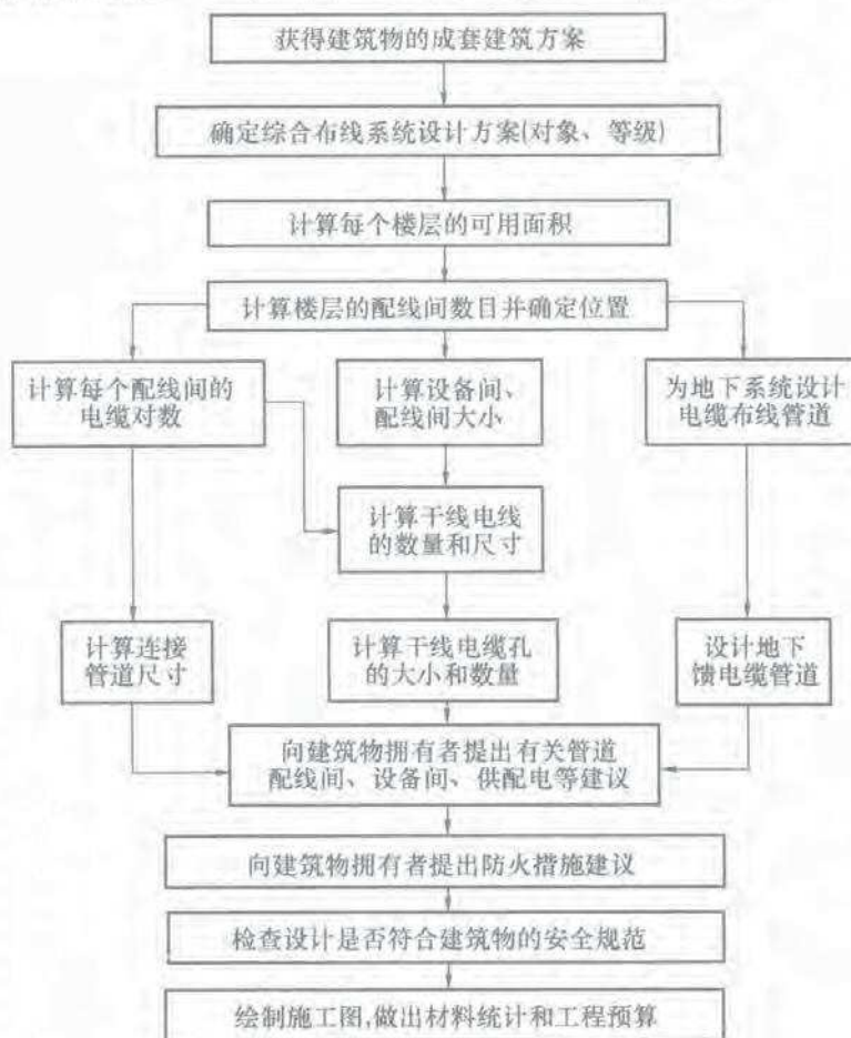
图 3-5 综合布线设计流程
