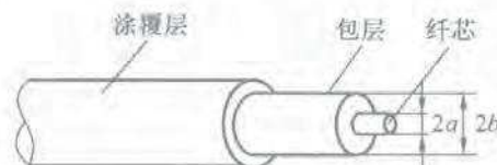
图 2-11 光纤的典型结构
