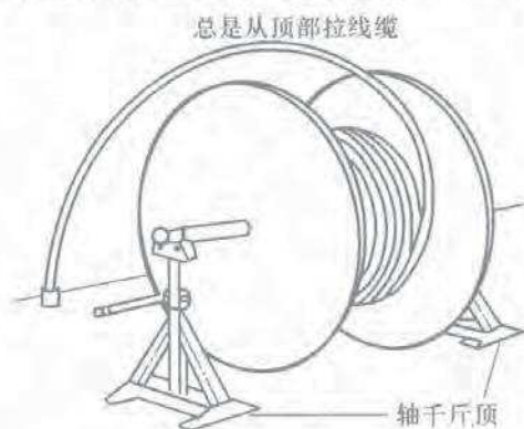
图 13-1 安放线缆卷轴并从顶部馈送线缆示意
