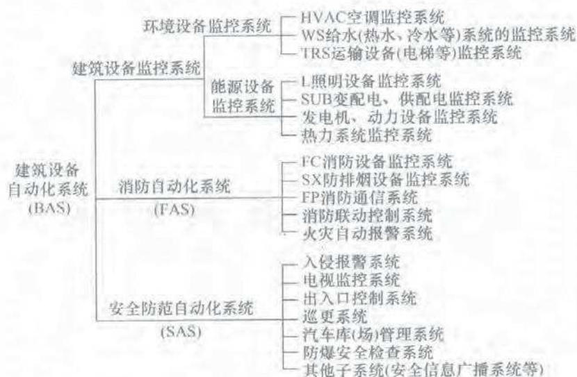
图 1-2 建筑设备自动化系统
