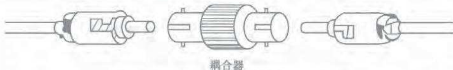
图 14-15 将 ST 连接器插到耦合器中
