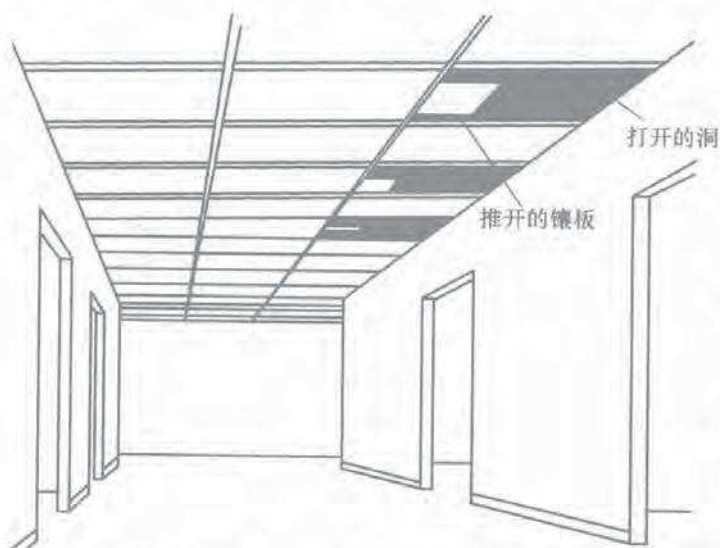
图 13-11 移动镶板的悬挂式天花板
