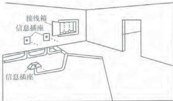
图 5-2 直接埋管布线方式
