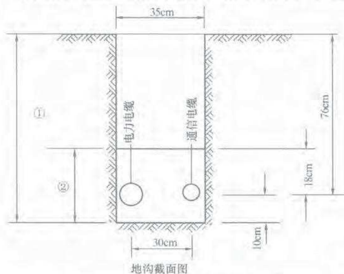
图 9-6 合理埋入地沟的断面示意
