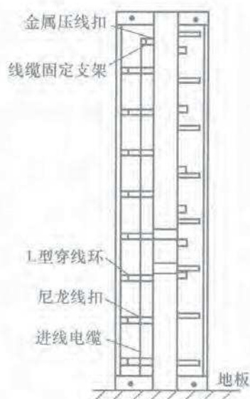
图 12-21 进线电缆管理安装
