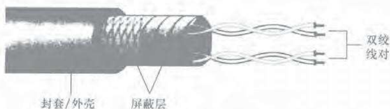
图 2-2 屏蔽双绞线(STP)电缆
