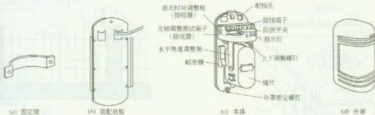
1. 主动红外入侵探测器结构
