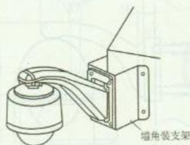
1. 球形摄像机墙角安装位置示意图
