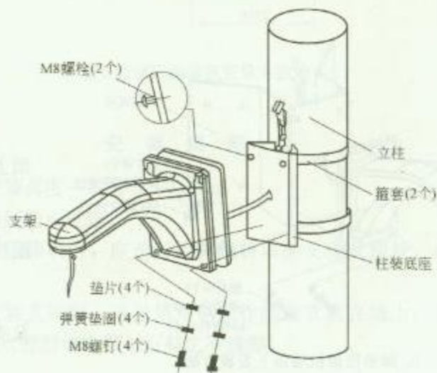
3. 球形摄像机柱装方法
