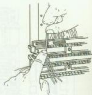
3. 紧压线对到位
