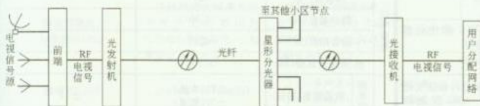
2. 有线电视光纤传输使用星形分光器的分支系统
