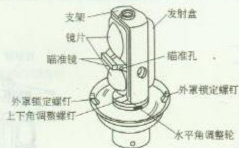
2. 入侵探测器内部结构图
