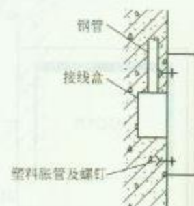
3. 磁卡门禁机安装方法
