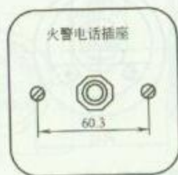
1. 火灾报警电话插座安装方法
