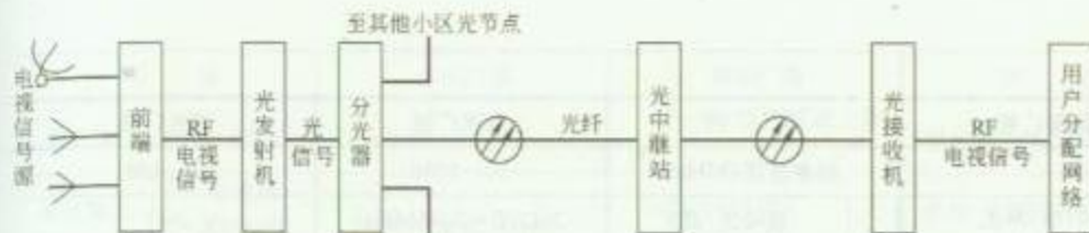
1. 有线电视光纤传输采用分光器的典型系统
