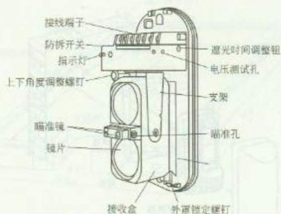
1. 双光束主动红外入侵探测器内部结构
