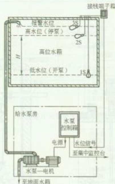
3. 给水泵控制安装方法 (二)
