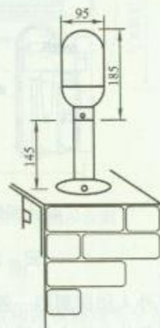
6. 入侵探测器墙顶部安装方法
