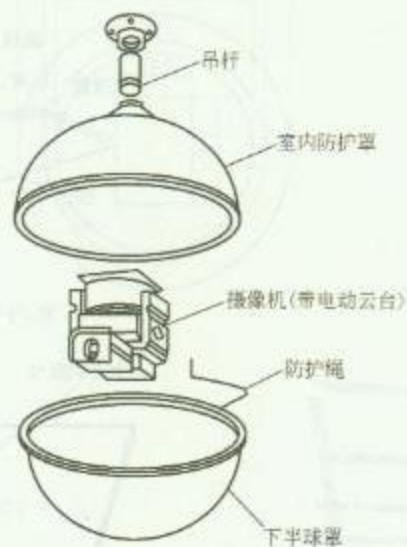
2. 室内球形带电动云台摄像机结构
