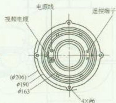
2. 半球形摄像机结构图
