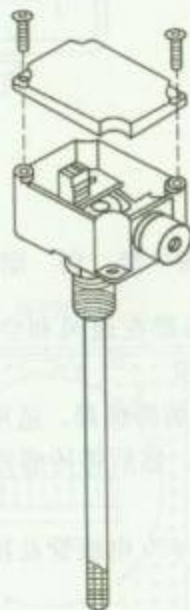
2. 温度传感器安装示意图
