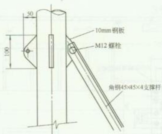
3. 支撑杆安装大样图 (一)
