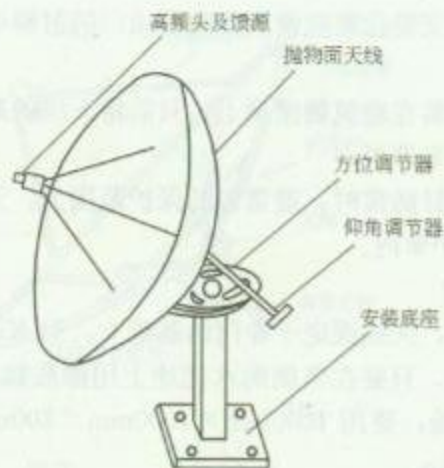
1. 3.5m 以下卫星天线结构示意图
