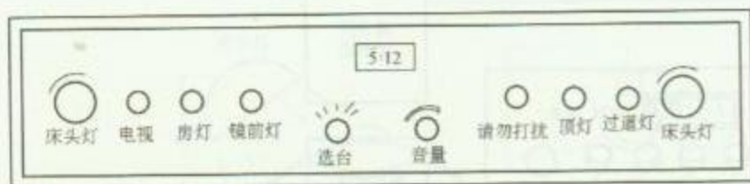
1. 床头集控板控制功能示例
