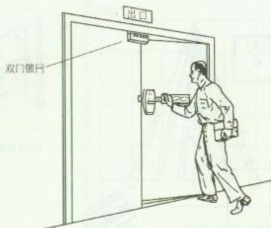
2. 双门锁闭安装示意图
