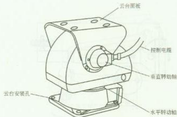
2. 双向电动云台结构图
