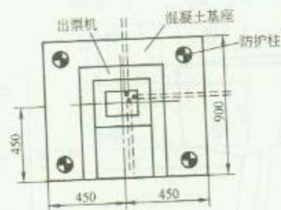
(b) 混凝土基础
