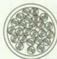
(a) 25 对非屏蔽 (UTP) 干线线缆
