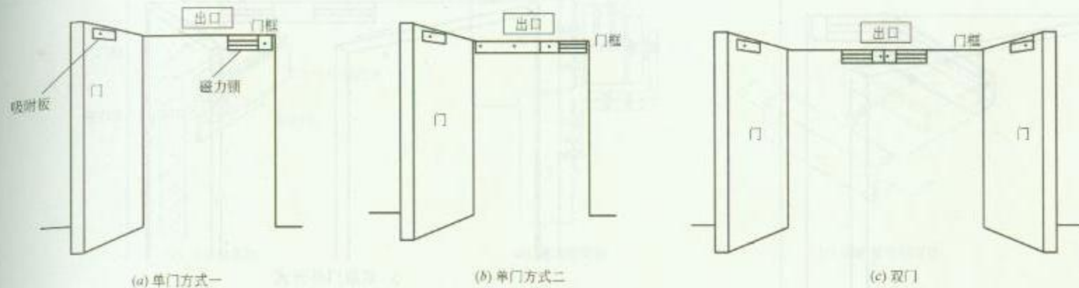
1. 磁力锁安装位置示意图
