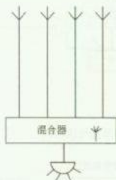
(a) 直接混合式前端用于强场强区
