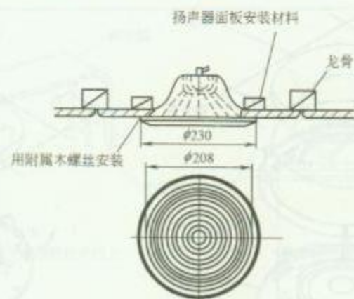
2. 扬声器在吊顶上嵌入安装方法 (二)
