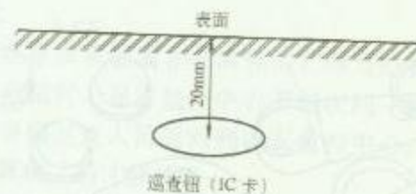
3. 读卡式信息钮隐蔽安装方法
