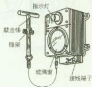
2. 消火栓箱内启泵按钮结构图
