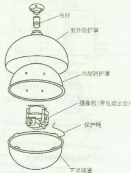
3. 室外球形带电动云台摄像机结构
