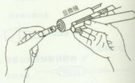
3. 将连接器插入显微镜作检查
