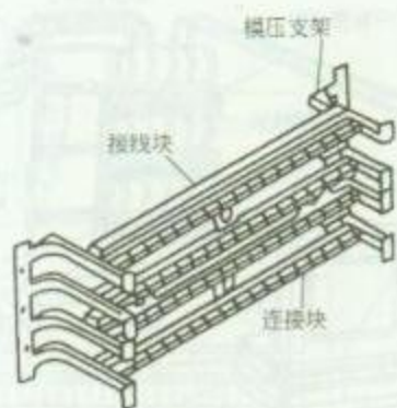
1. 100 对线的 110A 接线块组装件
