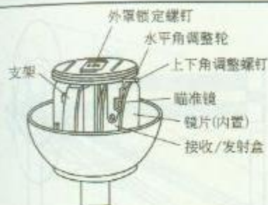
1. 入侵探测器内部结构图
