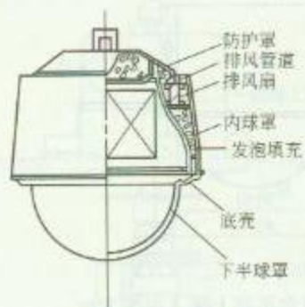
1. 室外球形防护罩结构图
