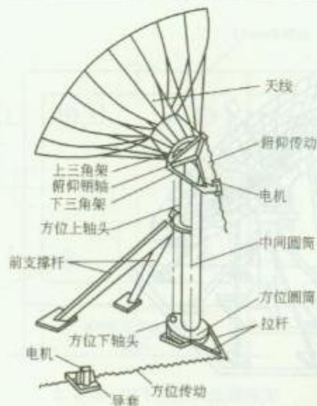
2. 7.5m 卫星天线结构示意图
