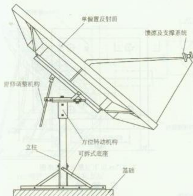
1.2m 卫星天线安装示意图
