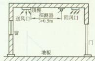
4. 探测器在有空调的室内安装位置图
