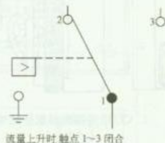
2. 气体流量开关触点功能
