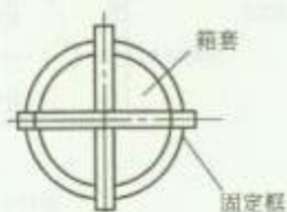
2. 扬声器箱在吊顶上嵌入安装方法 (二)
