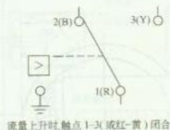
2. 液体流量开关触点功能
