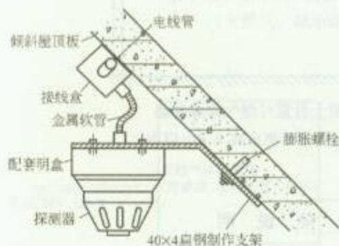
3. 探测器倾斜安装方法
