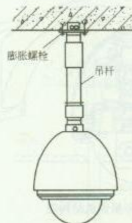
2. 摄像机安装方法
