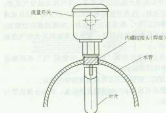
3. 液体流量开关安装方法
